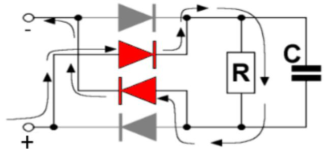
Tensione in uscita al ponte a diodi:
